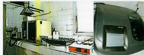
Spectrophotomètre d'Absorption Atomique (SAA) et ses accessoires (Digesteur, flamme, hydrure et four), pour l'analyse des traces de métaux lourds et de la qualité des engrais chimiques
