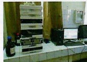
Chaîne de HPLC Agilent® pour l'analyse des herbicides
